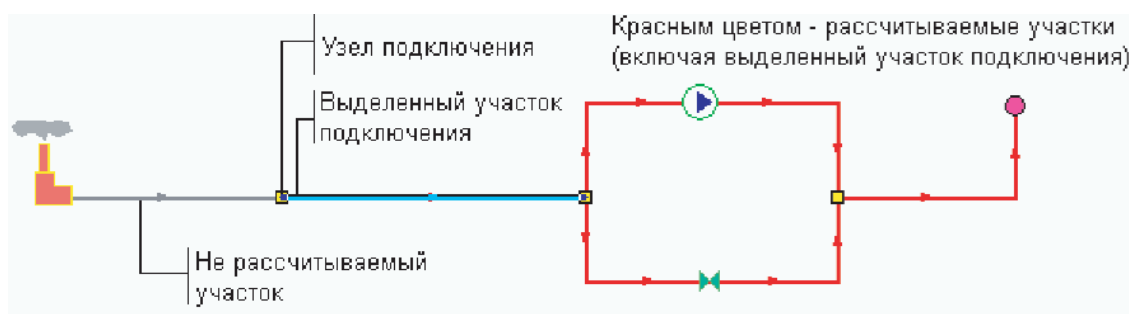
Рисунок 163 - Раскраска сети для конструкторского расчета
